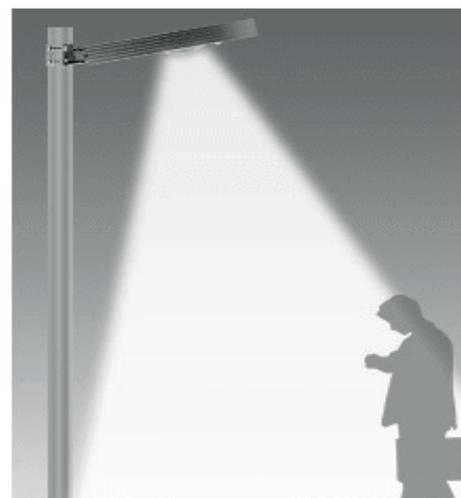
Quando la luce naturale dell'ambiente non è sufficiente e viene rilevato movimento di mezzi o persone, il sensore accende la lampada al massimo livello.
